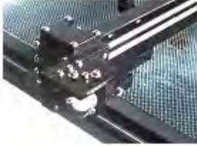
A close-up view of the X-axis carriage, showing the belt drive and the tensioning mechanism.  | Вторая крепежная скоба, отражающее зеркало, регулятор натяжения ремня.                                    |
