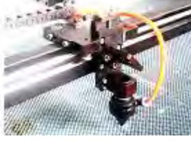
A close-up view of the X-axis rail, showing the cutting head and the laser tube.             | Рельса перемещения по оси X, режущая головка, лазер, фокусирующая линза находится внутри режущей головки. |
