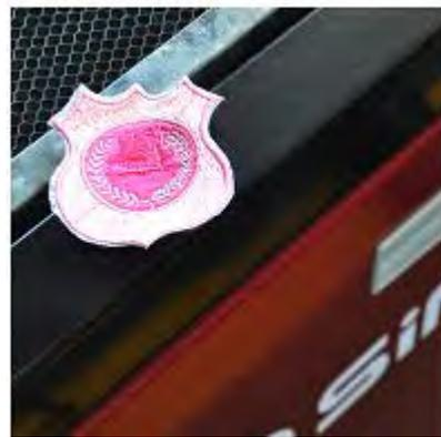
Вырезка логотипов, благодаря применению CCD обеспечивается точное позиционирование и захват контура.
