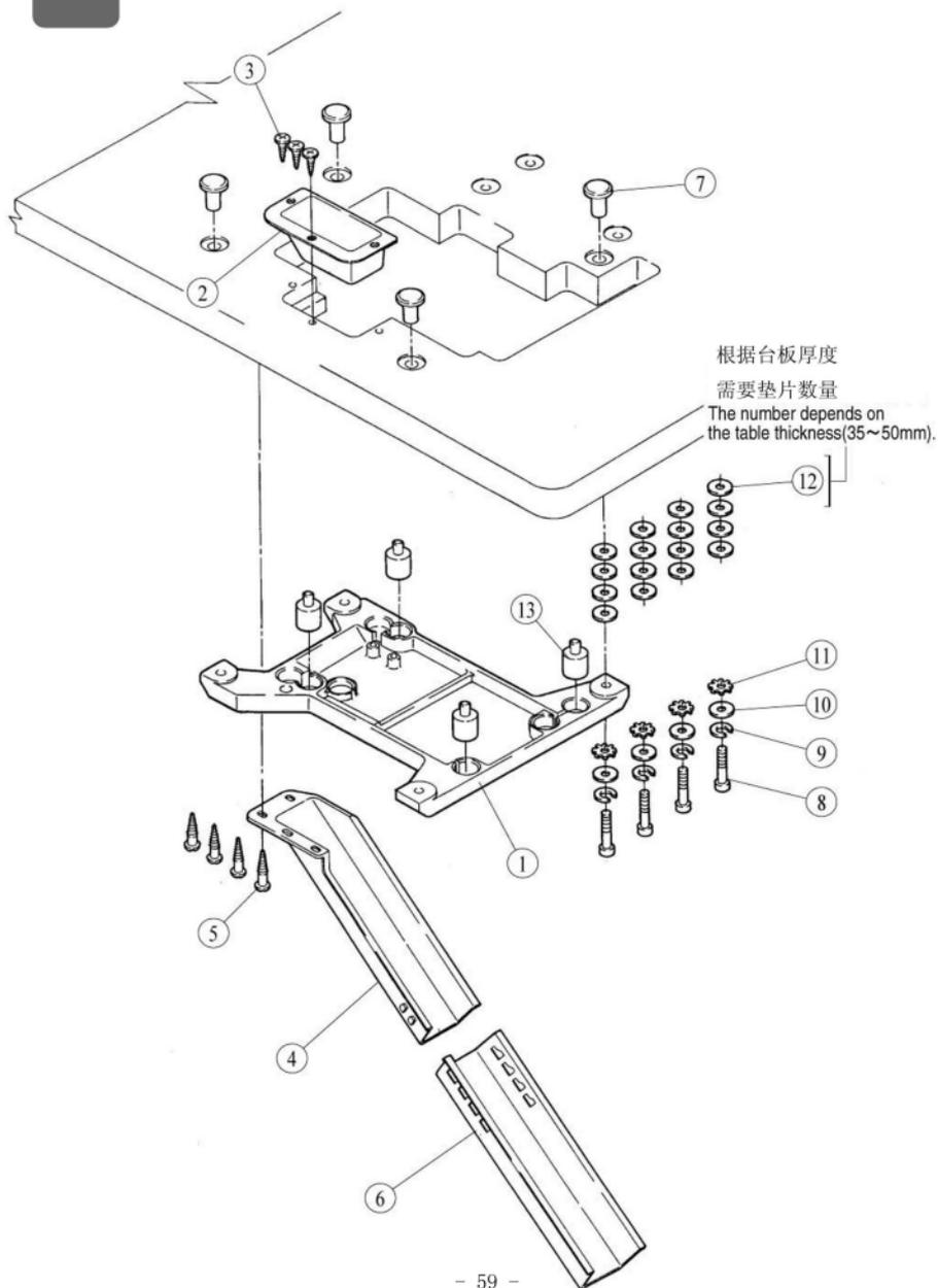
第二十二部件 托盘部件 (Machine Rest Board Assemblies)
