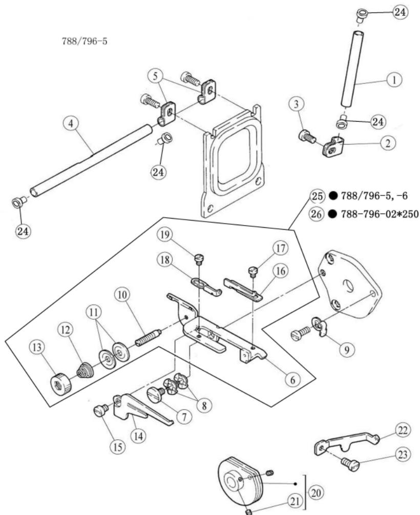
第十八部件 打线凸轮部件(Cam Assemblies)
