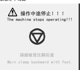
在机头运转过程中,如发生意外情况,可踩左边后退脚踏板来实现紧急停车功能,这时所有机械停止运转, 屏幕上会出现左图所示画面:
