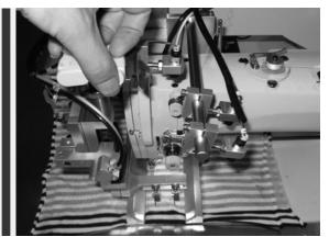
作用: 当在缝纫过程中发生断线时,屏幕上会出现上面左图所示画面,这时可重新穿好线, 然后通过断线补针开关使送布压脚回到重新缝纫位置:
